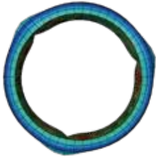
定向刻痕球囊 最高压强 2.782 MPa
