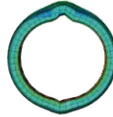
双导丝球囊 最高压强 2.036 MPa
